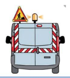
A l'arrière: 2 bandes de signalisation verticales et 2 bandes de signalisation horizontales d'une surface totale au moins égale à 0,32 m<sup>2</sup>
